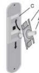
11. Para as maçanetas fixas, introduza a haste "A" no suporte "B". (fg. 11). Com as peças "A" e "B" na posição, introduza no suporte "C" pressionando para cima conforme mostra a seta, em seguida pressione para baixo conforme indicação da seta na (fg. 11).
