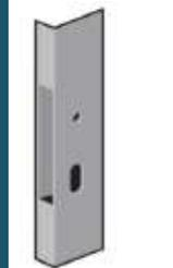
4. Utilize um formão para fazer o acabamento interno do furo ate que as paredes internas fiquem lisas. O espaço para encaixe deve ter folga mínima de 1 mm (fg. 4)
